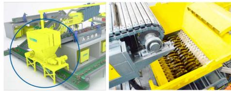
混合固废破碎技术，软硬通吃，可破碎多种混合固废：金属、木材、塑料、织物等。
